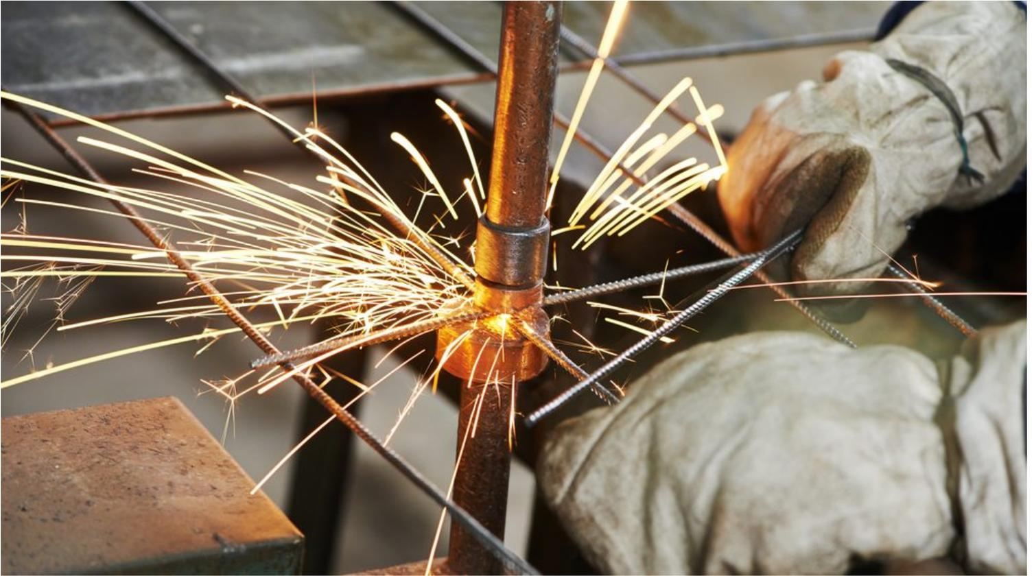
Schweißrauch ist beim Widerstandsschweißen nicht die größte Gefahr. Vielmehr rufen magnetische Strömungen beim Schweißprozess Risiken für die Gesundheit der Mitarbeiter hervor. Der Einsatz von Absaug- und Filtertechnik kann dennoch sinnvoll sein, zumindest mit einem Raumlüftungssystem. Das Schweißen verölter Bleche verursacht höhere Rauchmengen.
