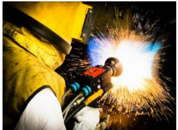
Aufgrund der hohen Partikelgeschwindigkeiten und Gefahrstoffmengen sind entsprechend hohe Erfassungsgeschwindigkeiten bei der Absaugung erforderlich (siehe **VDI 2262, Blatt 4 „Erfassen luftfremder Stoffe“**). Diese Kombination aus Spritzkabine und Absauganlage schützt die umliegenden Arbeitsplätze nicht nur vor Rauchen und Stäuben, sondern senkt auch den Lärmpegel, den das Thermische Spritzen verursacht.
