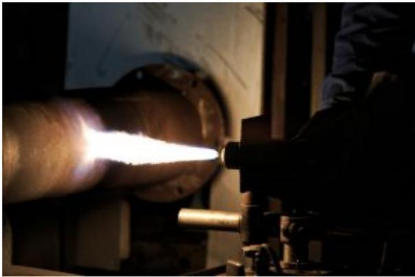
Zu den wesentlichen thermischen Spritzverfahren gehören das Flamspritzen, Lichtbogenspritzen und Plasmaspritzen. Diese unterscheiden sich hauptsächlich durch ihre Energiequelle. Zum Einsatz kommen entweder eine Brenngas-Sauerstoff-Flamme, ein elektrischer Lichtbogen oder ein Plasma- beziehungsweise Laserstrahl. Eine Gesundheitsgefahr
