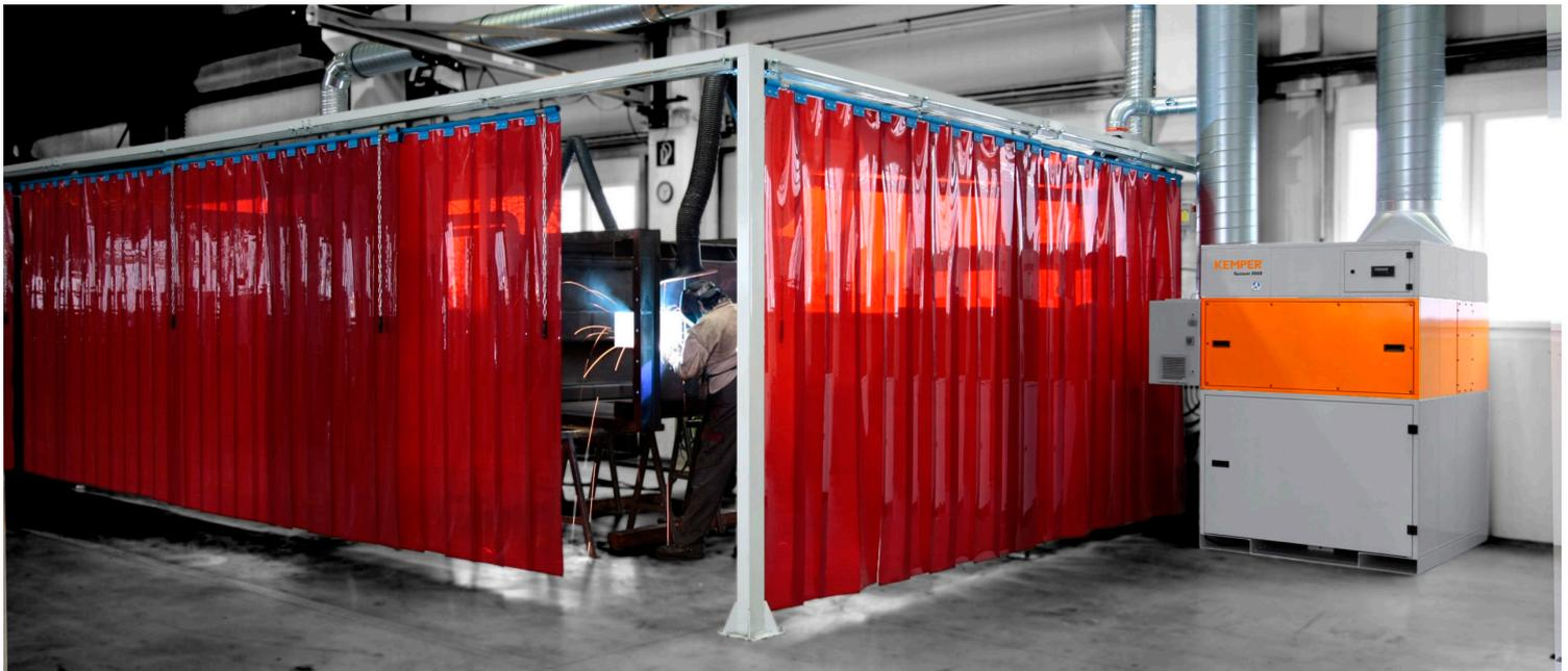
Für den Schall- und Arbeitsschutz aber auch als Abstandsvorrichtung zum Schutz vor dem Corona-Virus eignen sich vorzugsweise [mobile Trennwandsysteme](#). Diese sind als Schweißkabinen, Arbeitsplatzbegrenzungen sowie Hallenabtrennung einsetzbar. Für Betriebe sind sie jedoch vor allem eine kostengünstige und schnelle Einstiegslösung, um Mindestabstände einzuhalten. Die Trennwände sind innerhalb der Halle schnell und flexibel an anderen Plätzen aufstellbar, sollte sich ein Arbeitsplatz wechseln.
