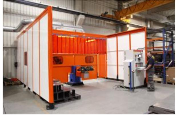
Dagegen hilft eine Art Raumlüftungssystem. Am Ende der Kabine saugt dieses kontinuierlich die kontaminierte Luft aus der Kabine ab. Eine angeschlossene zentrale Filteranlage reinigt die Gefahrstoffe ab und leitet die Luft wieder in die Halle zurück. Weil auf diese Weise ständig Luft aus der Halle in die Kabine nachströmt, wird ein Austreten von Schweißrauch verhindert.
