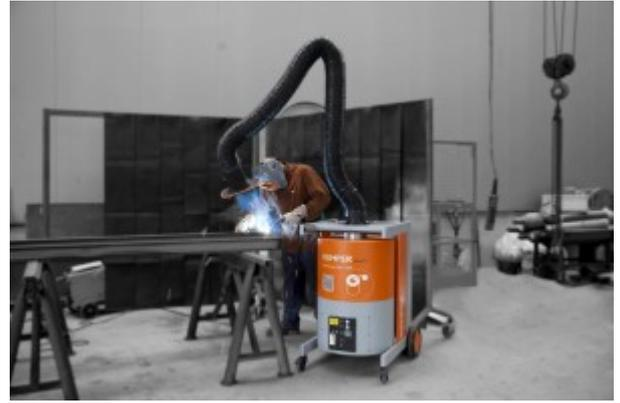
Somit kann sich der Schweißer ganz auf das Werkstück konzentrieren. (Wie die Beschaffenheit sein sollte, lesen Sie detailliert [hier](#).) Eine um [360 Grad schwenkbare Absaughaube mit Drosselklappe fördert die Ergonomie](#). Ist die Abdeckung zudem flanschförmig zu den Seiten, verhindert sie das Ansaugen von Falschluf und [erzielt einen deutlich höheren Erfassungsgrad als eine rein ovale Haube](#).
