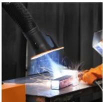
Niedrigvakuum-Punktabsaugungen sind in der Praxis am häufigsten. Die Schweißraucherfassung erfolgt über eine Absaughaube am Ende flexibler Absaugarme mit Längen bis zu zehn Metern. Diese sind im Idealfall freitragend und müssen dadurch nicht vom Schweißer während des Schweißprozesses gehalten werden. Eine gute Niedrigvakuum-Punktabsaugung erfasst den Schweißrauch je nach Einstellung auch noch in einem Abstand von 300 bis 400 Millimeter.
