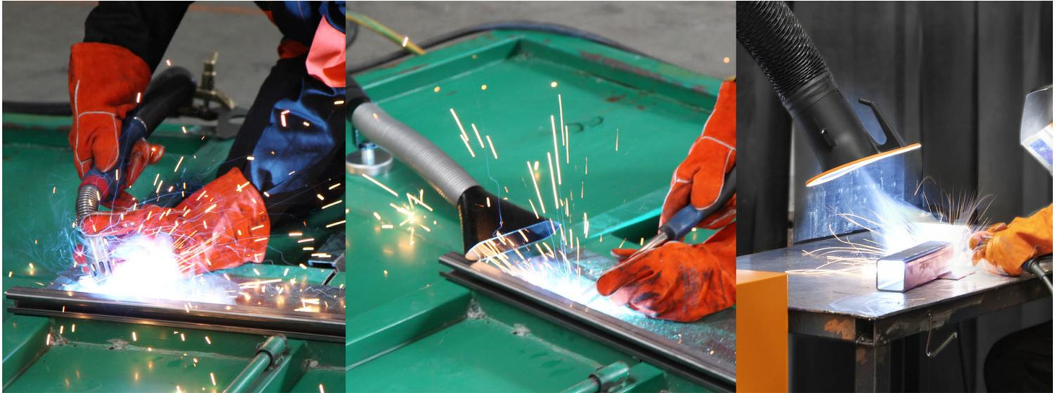
**Punktabsaugung ist bei der Auswahl des richtigen Equipments für die Schweißrauchabsaugung erste Wahl. Sie setzen unmittelbar an der Entstehungsstelle des Schweißrauchs an. Drei Arten von Punktabsaugungen gehen auf die unterschiedlichen Bedürfnisse beim Schweißen ein.**
