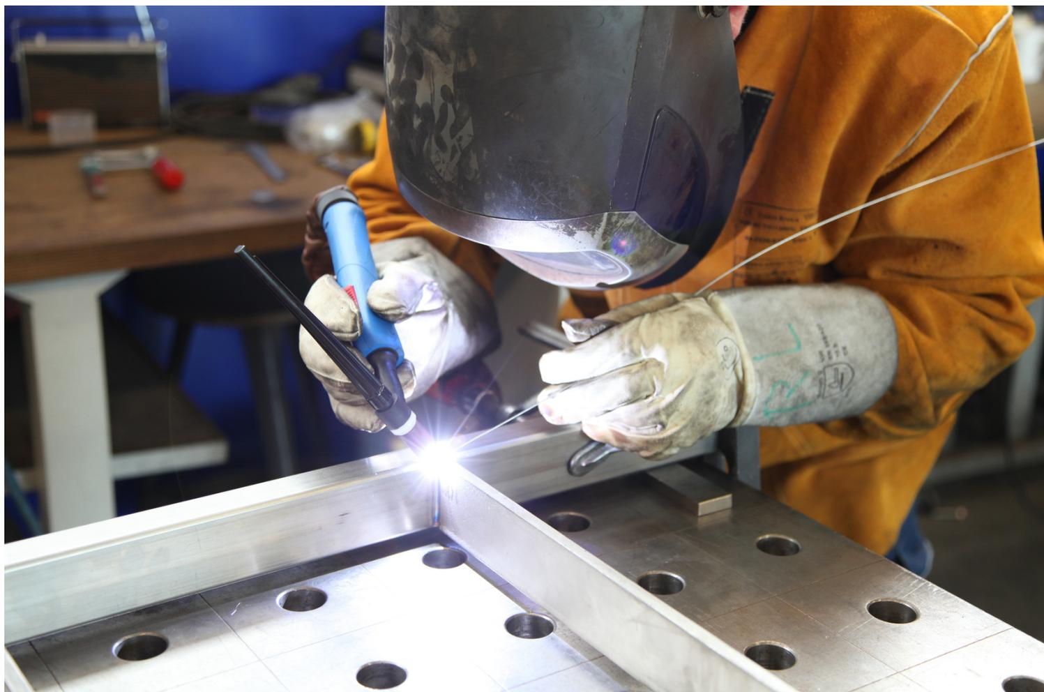
Schweißen von Aluminium ist eine Gefahr für Schweißer. Während Aluminiumoxide die Atemwege belasten, entsteht bei den typischen Schweißverfahren das noch gefährlichere Ozon.
