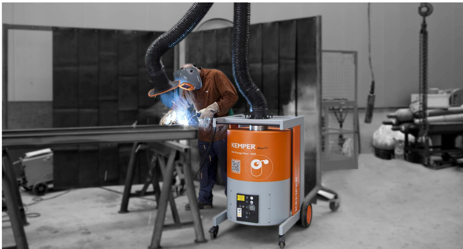
**Mobile Absauggeräte sind für viele Betriebe das Mittel der Wahl bei der Schweißrauchabsaugung. Insbesondere bei wechselnden Arbeitsplätzen entfalten die Punktabsaugungen auf Rollen ihre Vorteile gegenüber stationären Systemen. Welches Modell sinnvoll ist, hängt vom Einsatzgebiet und von der Schweißintensität ab. 12 Fakten, worauf Schweißer bei der Auswahl mobiler Absauggeräte achten müssen.**
