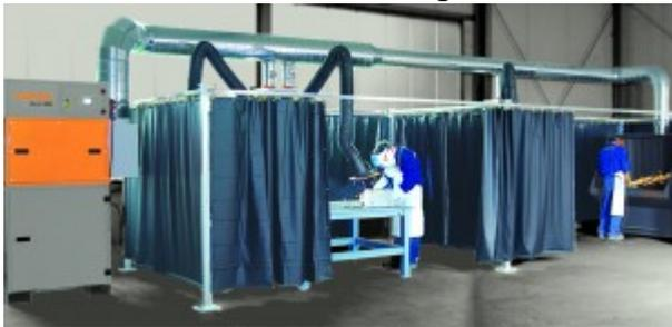
Regel nicht der Einsatz einzelner Geräte sinnvoll, sondern zentrale Absauganlagen sorgen dann für einen effektiven Arbeitsschutz.
