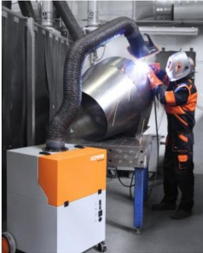
Bei der Anschaffung neuer Absauganlagen und Filtersysteme für Schweißrauch stellt sich schnell die Frage nach der Art der geeigneten Anlagen. Darauf haben verschiedene Faktoren Einfluss. Metallverarbeiter müssen sich unter anderem gleich mehrere Fragen stellen: Welche Möglichkeiten geben meine Produktionshallen für die Absauganlagen und Filtertechnik vor? Welche Werkstücke bearbeite ich in der Regel? Wüsche ich eine Fortluft-Lösung?
