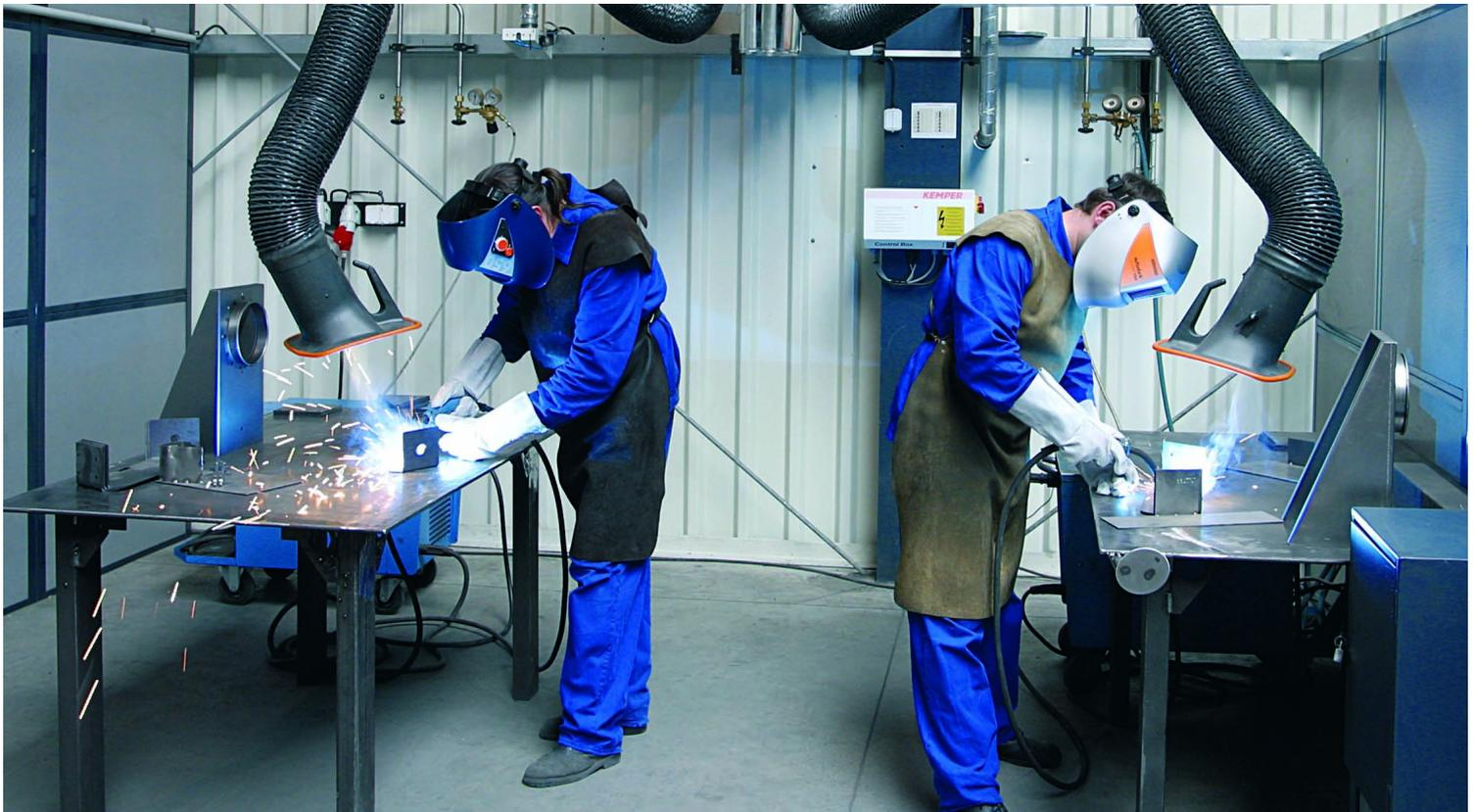
Die Bedürfnisse der Schweißer entscheiden über die Art von geeigneten Absauganlagen. Dies hängt von unterschiedlichen Faktoren wie den örtlichen Gegebenheiten ab. Metallverarbeiter haben grundsätzlich die Wahl zwischen mobilen und stationären Geräten bzw. zentralen Anlagen für die Absaugung von Schweißrauch.
