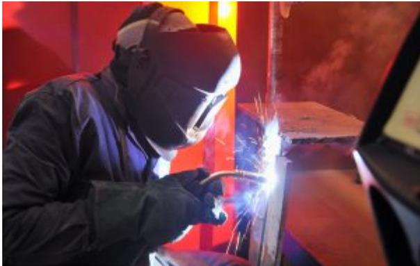
die verwendeten Gase in ihrer chemischen Zusammensetzung. Aus dem Schutzgas Kohlendioxid wird beim MAGC-Schweißen beispielsweise Kohlenmonoxid. Zum anderen wirkt auch der Lichtbogen auf die Entstehung von Gefahrstoffen ein. Beim MAG-Schweißen handelt es sich um ein Lichtbogenschweißverfahren: Eine endlose Drahtelektrode schmilzt dabei unter einer Schutzgasabdeckung ab, die vor Atmosphäre schützt.
