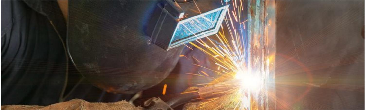
Seiner Beliebtheit vor allem in der Verarbeitung von Stählen zum Trotz ist das MAG-Schweißen eines der Verfahren mit den höchsten Emissionsraten an Schweißrauch. Welche Gefahrstoffe bei der Anwendung entstehen, hängt von der Art des speziellen Metallaktivgasschweißens (MAG) ab.
