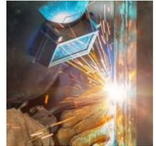
Auch partikelförmige Stoffe müssen bei der Gefährdungsbeurteilung berücksichtigt werden. Toxische Stoffe wie Manganoxid, das beim MAGM-Schweißen von Chrom-Nickel-Stahl mit Massivdraht entsteht, reizen bei hohen Konzentrationen die Atemwege und können das Nervensystem schädigen. Nickeloxid kann beim selben Verfahren Krebs erzeugen – ebenso wie Chrom-VI-Verbindungen beim MAGM-Schweißen von Chrom-Nickel-Stahl mit Fülldrahtelektrode.
