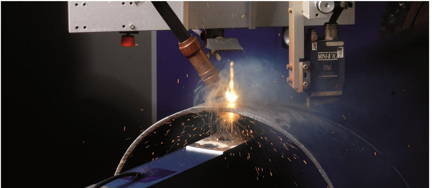
Entstehen überhaupt Gefahren durch Schweißrauch, wenn ein Roboter schweißt? Diese Frage stellen sich viele Schweißer beim Laserschweißen. Das nahezu automatisierte Schweißverfahren birgt vor allem dann Gefahren, wenn mit Zusatzwerkstoff gefertigt wird. Schweißrauchabsaugung sollte immer mit Absaughauben erfolgen.
