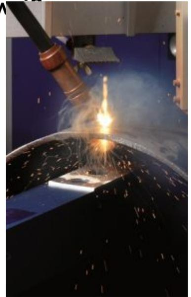
Die Schweißrauchmenge beim Laser-MSG-Hybrid-Schweißen ist vor allem abhängig von der Kombination aus Laser und dem gewöhnlichen MSG-Schweißverfahren. In der Regel wird **MAG**-Schweißen hier kombiniert, aber auch **MIG** und **WIG** können zugesetzt werden. Weil Abschmelzleistung und Vorschubgeschwindigkeit des Hybridschweißens viel höher als bei den gewöhnlichen Verfahren sind, weist das Laserschweißen höhere Schweißrauchmengen auf als nicht automatisierte Verfahren.
