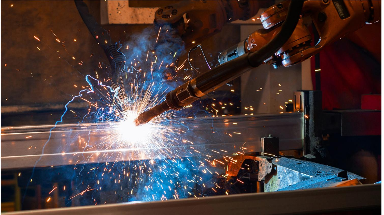
Gefahrenpotenziale erkennen und professionell beseitigen: eine der vielen Herausforderungen im Karosserierohbau. Denn bei den Schweißarbeiten mit Verbundwerkstoffen wie Aluminium und Stahl entstehen unter anderem Gefahrstoffe wie Oxide und Ozon. Werden diese nicht fachgerecht abgesaugt, können sie zu folgeschweren Atemwegserkrankungen führen. Mögliche Schutzmaßnahmen sind Absaughauben und die Erfassung der Stoffe an der Gefahrenstelle.
