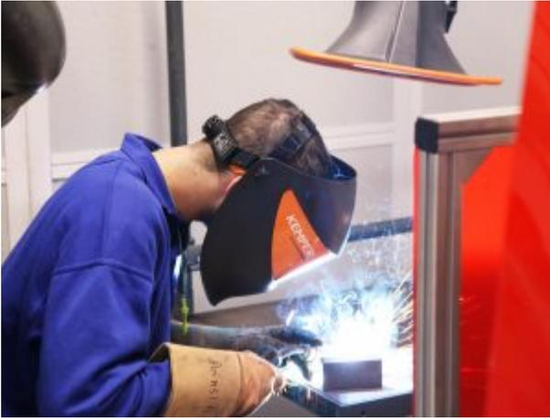
Neun Schweißkabinen wurden speziell für das MAG- und MIG-Schweißen mit starkem Lichtbogeneinsatz integriert. Jeder geschützte Arbeitsplatz verfügt über einen eigenen Absaugarm, der wiederum an die zentrale Absaug- und Filteranlage angeschlossen ist. Die Schweißkabinen bestehen aus speziellen Schallschutzwänden und verschiebbaren Schweißerschutzlamellen mit individuellem Überlappungsgrad.
