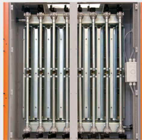
**Bei Absaug- und Filteranlagen kommen je nach Filtersystem unterschiedliche Elemente zum Einsatz. Eine bewährte und effiziente Variante sind Filterplatten, da sie eine sehr lange Lebensdauer aufweisen und somit Kosten sparen.**
