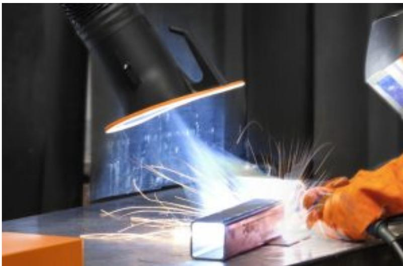
Das Besondere beim Schweißen gegenüber der Außenwelt: Schweißer ohne Absaug- und Filtertechnik atmen verschmutzte Luft an der Entstehungsstelle direkt ein. Schweißer sind dabei durch die Werk- und
