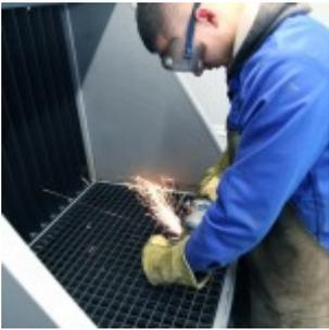
Die Seitenwände sind mit Schalldämmmaterial ausgestattet. Grobe Partikel fallen in eine Staubsammellade.
