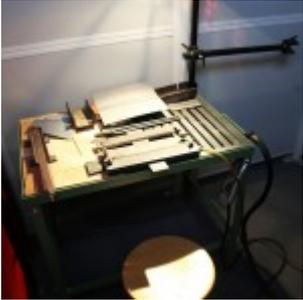
... und ein Stabeisenrost für die Tiefschweißung. Eine Zwangslagenschweißvorrichtung ist in allen Tischen integriert. Damit die Umgebung um den Schweißplatz auch vor Geräuschemissionen geschützt ist, ist pro Schweißplatz jeweils eine Schweißkabine mit speziellen Schallschutzwänden integriert.
