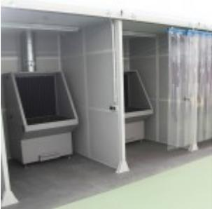
Neben den Schweißkabinen verfügt die modernisierte Bildungsstätte über sechs Schleifkabinen aus Schallschutzwänden mit verschiebbaren transparenten Lamellenvorhängen.
