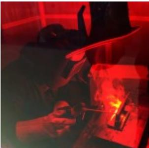
Abgedunkelte und verschiebbare Schweißlamellenvorhänge schützen den Eingangsbereich der Kabine. Weiterer Vorteil: Alle Schweißkabinen sind mit einem abgedunkelten Sichtfenster ausgestattet. Dadurch laufen die Schweißlehrer nicht Gefahr, beim Blick in den Lichtbogen sich die Augen zu verblitzen.
