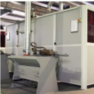
Darin sind jeweils ein herausnehmbarer Schrottkasten und eine Werkstück-Klemmvorrichtung zur Aufnahme von Brennschneidgeräten integriert. Die Tische sind über eine Trittmekanik bedienbar und ebenfalls an die zentrale Absaugung angeschlossen.
