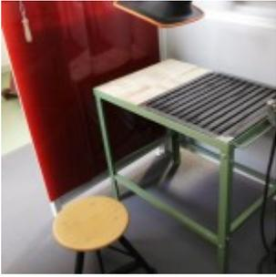
Auch die Ausstattung an den Schweißtischen verspricht beste Ausbildungsbedingungen. Diese verfügen über eine Stahlblechauflage mit Schamottplatten für die Flachschiweißung...
