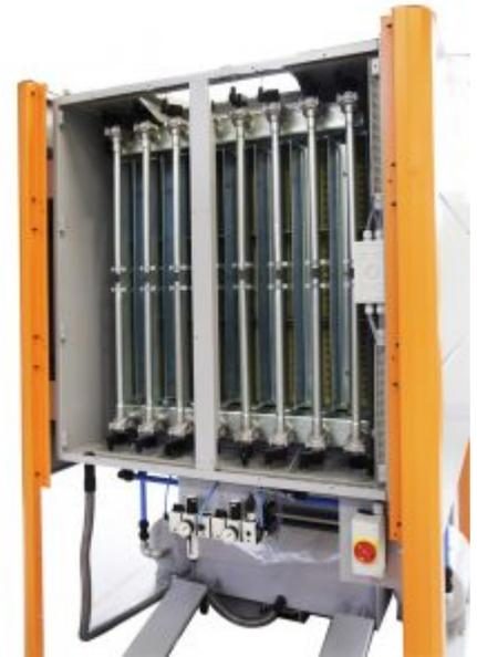
Aufgrund der horizontalen Aufstellung der Filtertechnik erfolgt die Abreinigung im Down-Flow-Prinzip. Nach Bedarf führt die Absauganlage diese automatisch aus. Die Gefahrstoffe werden mittels Druckluftstößen „abgeschüttelt“. Aus der Filterkammer gelangen sie dadurch direkt in den darunter liegenden Staubsammelbehälter. Weil dieser mit einer Drucklufthebevorrichtung verschlossen wird, erfolgt die Staubsammlung kontaminationsfrei.
