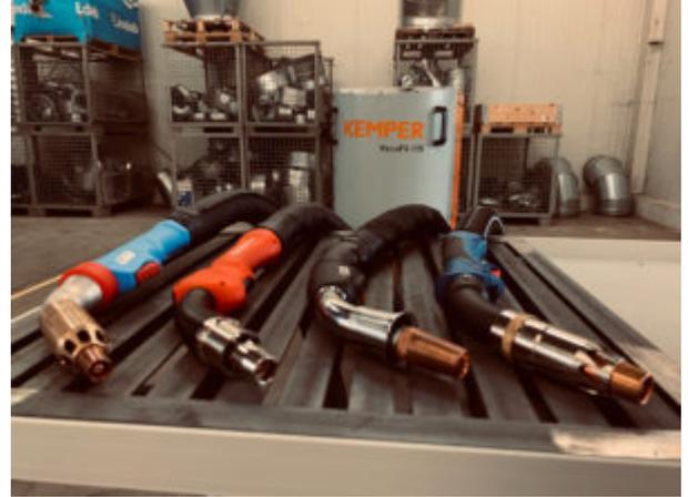
Zu den Faktoren gehören natürlich die richtige Handhabung, aber auch einige Einstellparameter, die laut DVS bisher für den Schweißer nicht relevant waren. Besonders wichtig hierbei sind die richtige Absaugleistung und der dafür erforderliche Unterdruck. Diese Parameter sind je nach Absaugbrenner unterschiedlich und am Absauggerät einstellbar. Nur mit den passenden Werten ist eine optimale Erfassung der Gefahrenstoffe im Schweißrauch gewährleistet.
