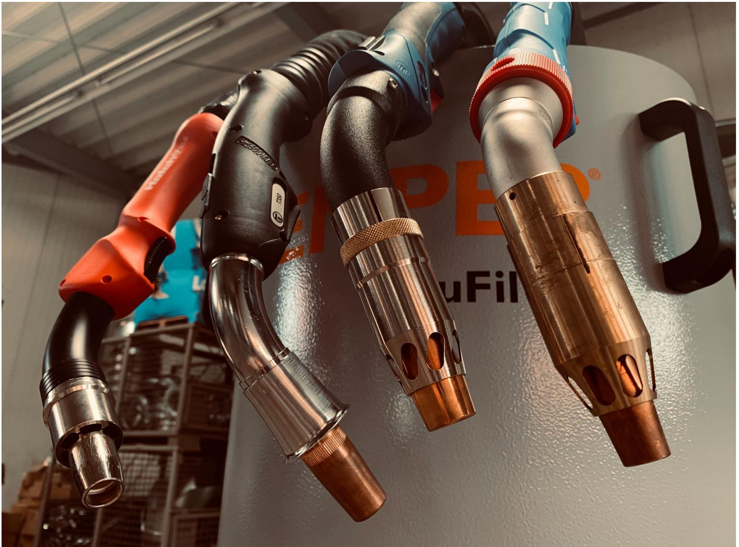
Brenner mit integrierter Schweißrauchabsaugung sind praktische Helfer beim Metallschutzgasschweißen (MSG). Sie erfassen den Schweißrauch punktgenau dort, wo er entsteht. Damit sie optimal funktionieren, müssen Schweißer jedoch einige Einstellparameter berücksichtigen.
