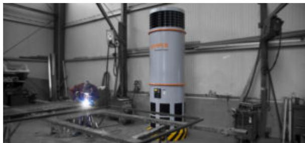
Lüftungsverfahren ohne Erfassungselemente in der Nähe der Schweißstelle sind als alleinige Schutzmaßnahme für die Schweißer nicht zulässig. Diese Verfahren tragen nur zur Reinigung der Luft im Umgebungsbereich bei, sind also nur eine ergänzende Maßnahme zur Schweißrauchabsaugung im Entstehungsbereich. Damit gemeint sind
