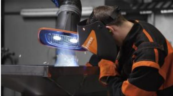
Der Absaugarm ist in Schweißbetrieben zu einem Großteil das Mittel der Wahl, wenn es um **Punktabsaugung** geht. Und genau diese wird für eine effektive Schweißrauchabsaugung empfohlen. Punktabsaugung erfasst den Schweißrauch unmittelbar an der Entstehungsquelle, ohne dass er in die Hallenluft entweicht. Im Vergleich zu anderen Absaugarten wie der brennerintegrierten Punktabsaugung oder Hochvakuum-Punktabsaugung hat die Niedrigvakuum-Punktabsaugung mittels Absaugarm einen größeren
