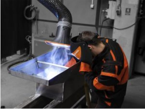
Darüber hinaus kann der Schweißer den flexiblen und freitragenden Absaugarm optimal auf seine eigene Größe und Arbeitsposition einstellen. Zudem nimmt er keinen Raum am eigentlichen Arbeitsplatz in Anspruch, da er freitragend in der Luft bleibt.
