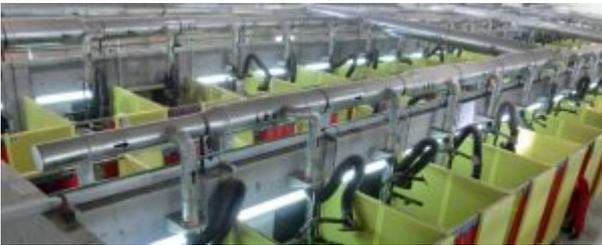
4. **Flexible Absaughaube:** Die an den Absaugarm angeschlossene Absaughaube trägt entscheidend zur Arbeitsqualität bei. Denn auch sie unterstützt die Flexibilität. Um 360 Grad drehbar, ist der Schweißer in der Lage, den Absaugarm in jede von ihm vorgegebene Position einzustellen. Dabei hilft ein robuster Griff.
