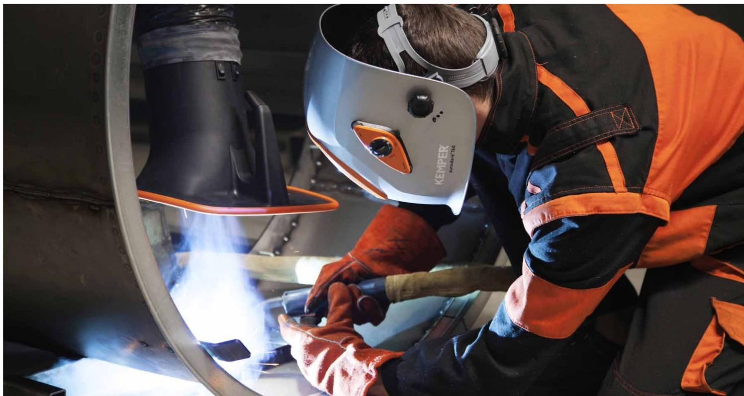
Ein Absaugarm soll Schweißrauch unmittelbar an der Entstehungsstelle erfassen. Doch nicht immer behagt Schweißern das Handling insbesondere beim Nachführen. Im Optimalfall aber unterstützt ein Absaugarm Schweißer bei der Arbeit: zehn Fakten, wie ein Absaugarm beschaffen sein muss.
