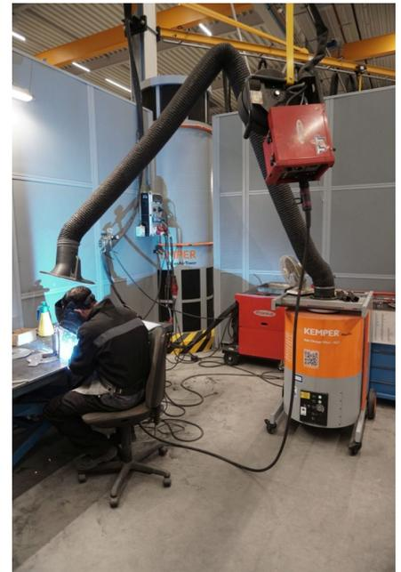
Vor diesem Hintergrund entwickelte KEMPER einen auf die Nobels-Bedürfnisse zugeschnittenen Maßnahmen-Mix aus Punktabsaugungen und Raumlüftungssystemen. An allen acht Schweißplätzen kommt jeweils ein mobiles Absauggerät mit der größten am Markt verfügbaren Filterfläche in dieser Geräteklasse
