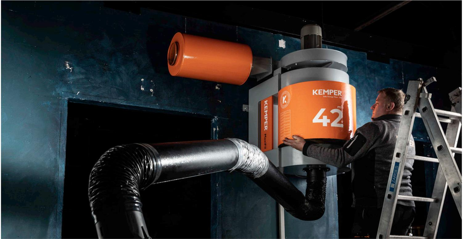
W3 ist der Qualitätsstandard für Absauggeräte schlechthin. Doch damit erfassen Metallbetriebe keineswegs per se dauerhaft rechtskonform Schweißrauch. Voraussetzung für die Beibehaltung der wichtigen IFA-Zertifizierung ist der Einsatz von originalen Verschleiß- oder Ersatzteilen. Denn auch sie sind elementare Bestandteile der W3-Prüfung: 9 Fakten, wie sich der W3-Status erhalten lässt.
