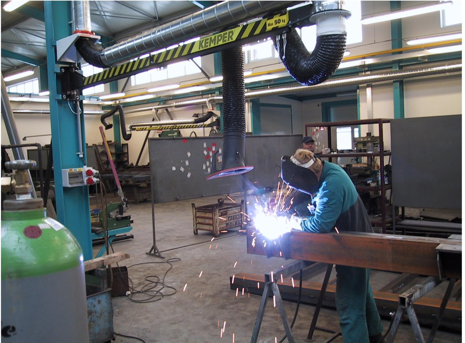
**Eine der Hauptursachen für Brände bei schweißtechnischen Arbeiten ist der unsichtbare Schwelbrand. Er wird ausgelöst durch Funken, die sich beim Schweißen nicht vermeiden lassen. Doch man kann sich vor den Gefahren eines Funkenflugs schützen.**
