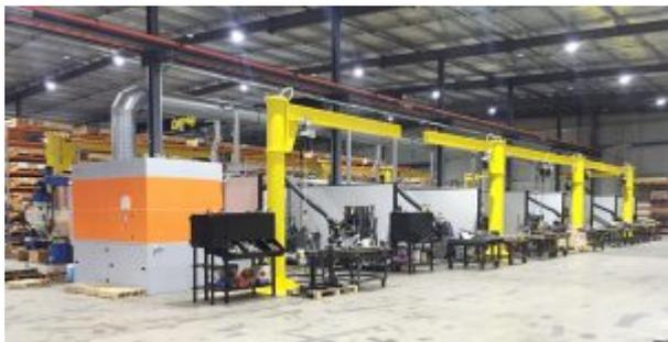
Die Filteranlagen vom Typ System 9000 eignen sich für große Staubmengen und scheiden mehr als 99,99 Prozent der alveolengängigen Partikel aus der kontaminierten Luft ab. Die speziellen ePTFE Membran-[Filterpatronen](#) für die Abscheidung von Feinstaub erfassen selbst Partikel unter 0,1 µm. Die automatische Filterabreinigung ermöglicht einen unterbrechungsfreien Betrieb. Die Absauganlagen laufen dabei geräuscharm. Die Staubsammlung erfolgt dank der
