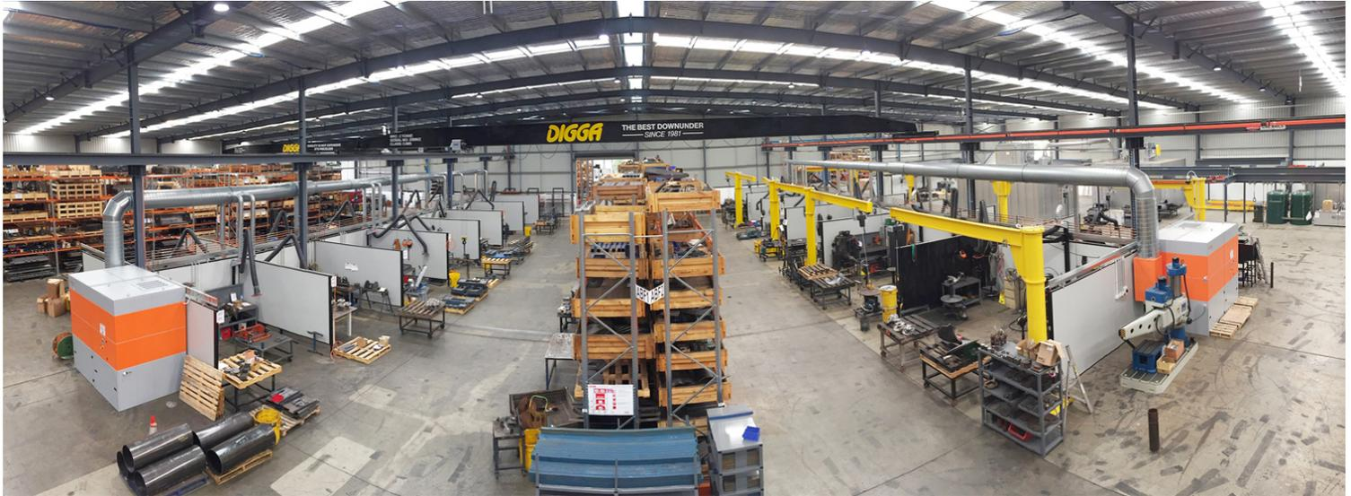
Absaugtechnik ohne Grenzwerte: Bis heute hat Australien keinerlei gesetzliche Vorgaben hinsichtlich der Höchstgrenzen von Feinstaub. Doch der Gerätehersteller DIGGA stattete seine neue Fertigung trotzdem mit moderner Absaugtechnik aus. Dazu zählen Absaugarme und hocheffiziente Filteranlagen.
