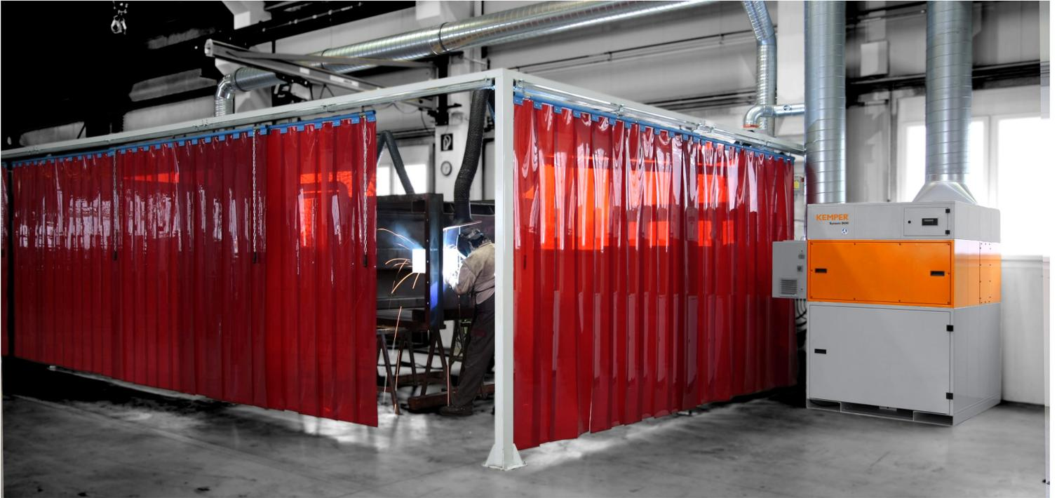
Effektiver Arbeitsschutz in metallverarbeitenden Betrieben macht nicht nur die Arbeit des Schweißers sicherer, sondern von jedem Mitarbeiter in der Werkshalle. Denn Strahlung, Lärm und Schweißspritzer gefährden auch unbeteiligte Personen in der Umgebung des Arbeitsplatzes. Moderne Abschirmungssysteme grenzen die Schweißplätze voneinander ab, schützen vor Strahlungsreflektionen und dienen als Sichtschutz.
