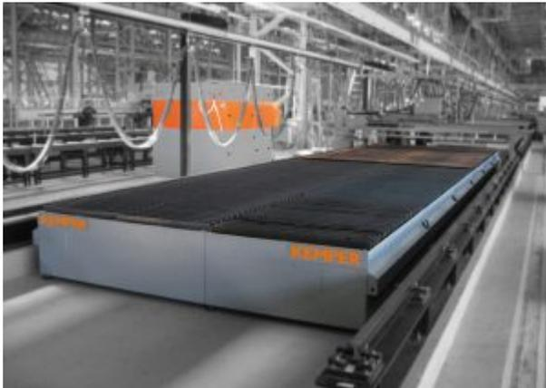
Daher sorgt bei Schneidanwendungen – wie beim Schweißen die Schweißrauchabsaugung – ein Absaugtisch für effektiven Arbeitsschutz und dafür, dass Grenzwerte eingehalten werden, die ohne Absaugung sehr schnell überschritten würden.
