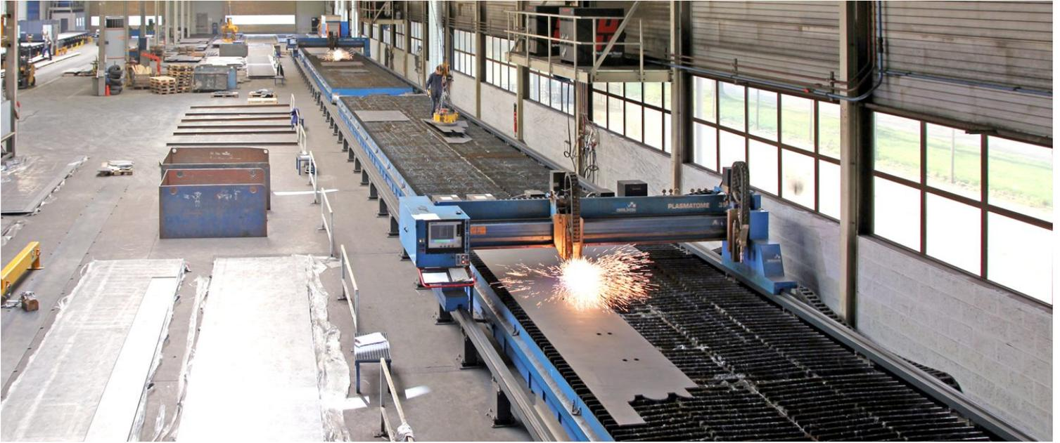
Wo geschweißt wird, ist ein Absaugtisch für Schneidanwendungen oft nicht weit. Er dient nicht nur der Materialaufgabe, sondern sorgt bei der Bedienung der Schneidanlage für die Sicherheit der Mitarbeiter bei großen Feinstaubmengen – sieben Fakten, was einen effektiven Absaugtisch ausmacht.
