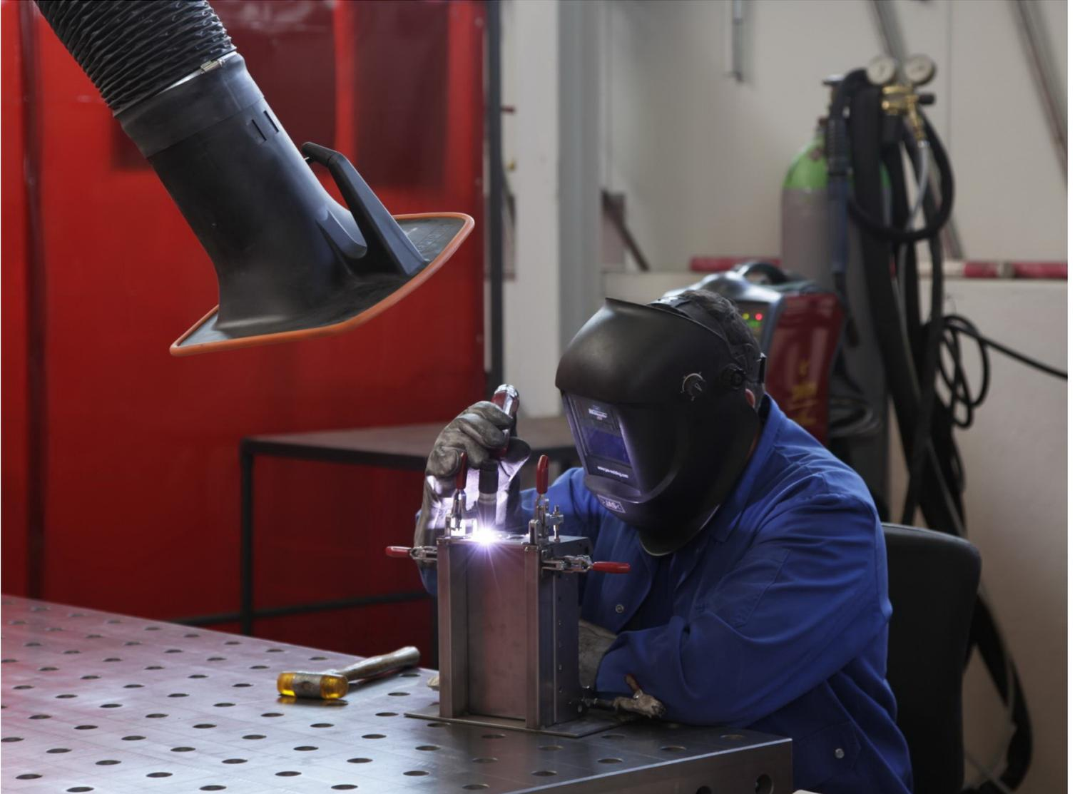
Eine richtig konzipierte Absaughaube hilft dabei, den Arbeitsschutz effektiv sicher zu stellen. Das mag für viele Schweißer erst einmal zweifelhaft klingen. Denn das Nachführen von Absaugarmen an den Absauganlagen lenkt von der eigentlichen Arbeit ab. Eine optimale Beschaffenheit der Absaughaube
