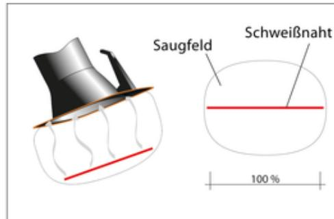
Absaughaube mit flanschförmiger Abdeckung
